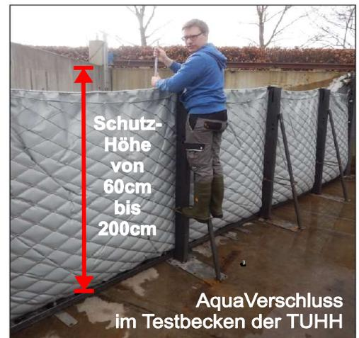
Der günstige AquaVerschluss wird einfach zum Einsatzort gebracht und mit kleinen Handgriffen aufgebaut.
