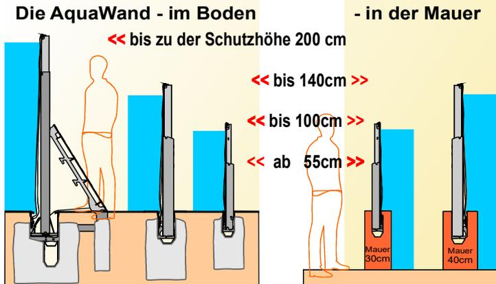
Die Schutzhöhen der AquaWände sind von 55 cm bis 200 cm wählbar. Die verschiedenen AquaWand-Typen können in einen Graben, in eine Mauer oder einen Deich eingebaut werden.
