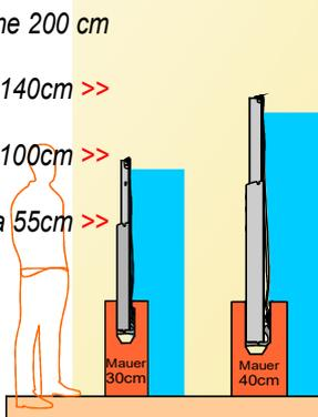
Le altezze di protezione degli AquaWalls possono essere selezionate da 55 cm a 200 cm. I diversi tipi di AquaWand possono essere installati in trincea, a parete o in diga.
